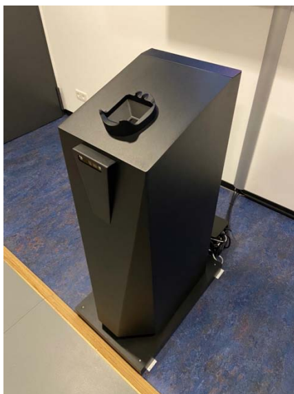
Abb. 2 Tower mit 3D-Tiefenkamera und Handvenenscanner
